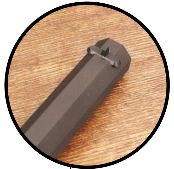
Sulla canna è fissato mediante incastro a coda di rondine il mirino a V rovesciata, spostabile in senso laterale per la correzione del tiro.
