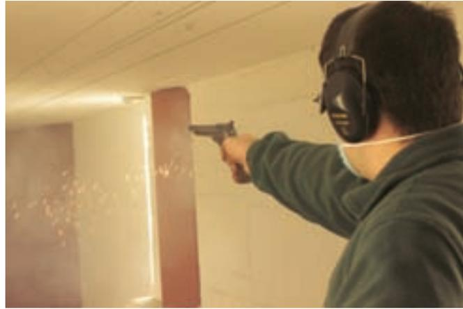
La prova con il revolver Whitney calibro .36. Con le armi corte, anche la polvere Ffg, più fine rispetto alla Ffg, ha evidenziato proiezione di lapilli. Sotto: la prova con il fucile Pedersoli Frontier calibro .45. Nella lunga canna del Frontier, la deviazione standard è stata particolarmente contenuta.
