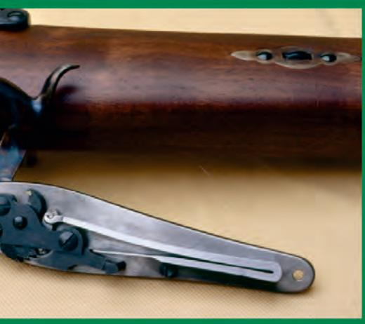
Interno dell'acciarino, con il cane in posizione di riposo e armato.
