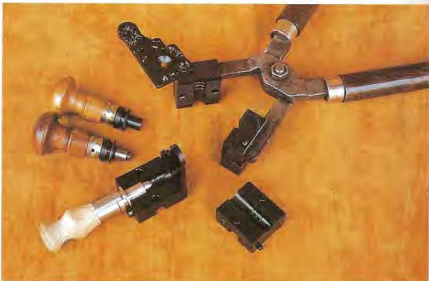
Sopra: a confronto gli inserti per ottenere tre tipi di palle diversi. Dalla palla solida, la più pesante, adatta ai tiri lunghi, meglio se avvolta in carta (paper patched), si passa alla palla tuttofare, con una piccola cavità in coda per un'espansione controllata. In posizione sullo stampo, l'inserto artigianale per la palla leggera utilizzata nella fase finale della prova a fuoco.
