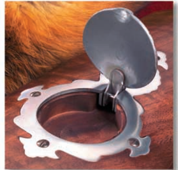
Klappe auf: Der Deckel des kleinen Pflasterfachs öffnete sich beim Schießen mehrmals ungewollt. Dem Element fehlt eine Sperre oder eine kräftige Stützfeder, um zu verhindern, daß sich Schußpflaster und Ersatzpistons über den Schießstand verteilen.
