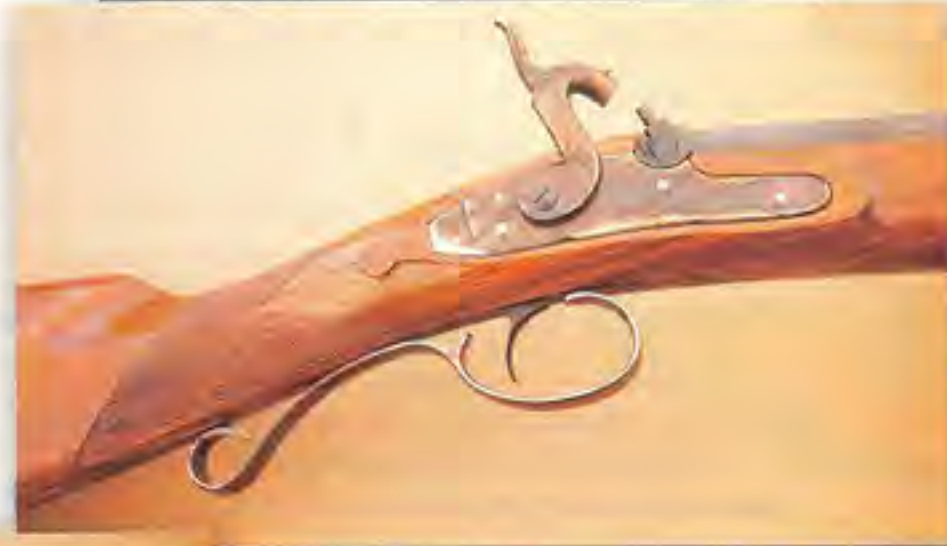
Le montage de la platine dans la boiserie a été particulièrement soigné. La course du chien est modérée et ses abattus sont d'une grande vigueur. Le poignet de la crosse a été quadrillé pour favoriser la bonne tenue de l'arme.
