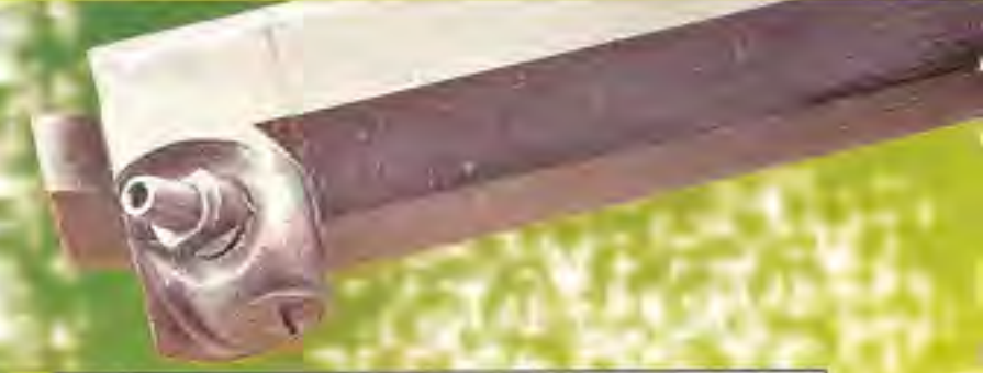
La masselotte portant la cheminée est solidaire de la culasse à crochet vissée à l'arrière du canon. Sur son flanc, elle possède une vis de visite dont le retrait simplifie beaucoup le nettoyage du canon et de la chambre.
