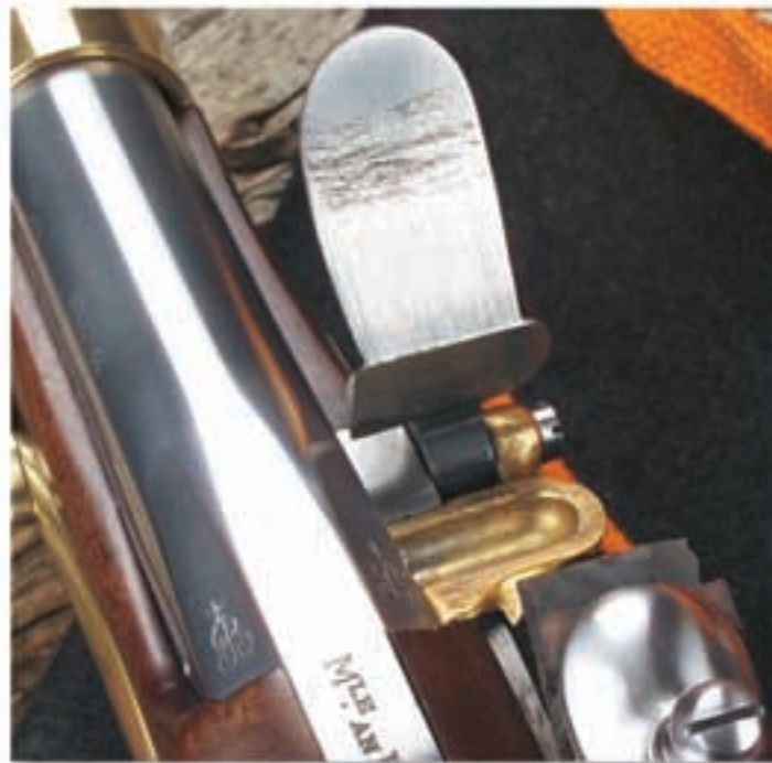
Die Zündpfannen der französischen Ordonnanzwaffen waren aus Messing gegossen und nicht mehr aus Eisen geschmiedet. Das reduzierte in der Manufaktur den Fertigungsaufwand und wirkte gegen die Korrosion der Schwarzpulverreste.
