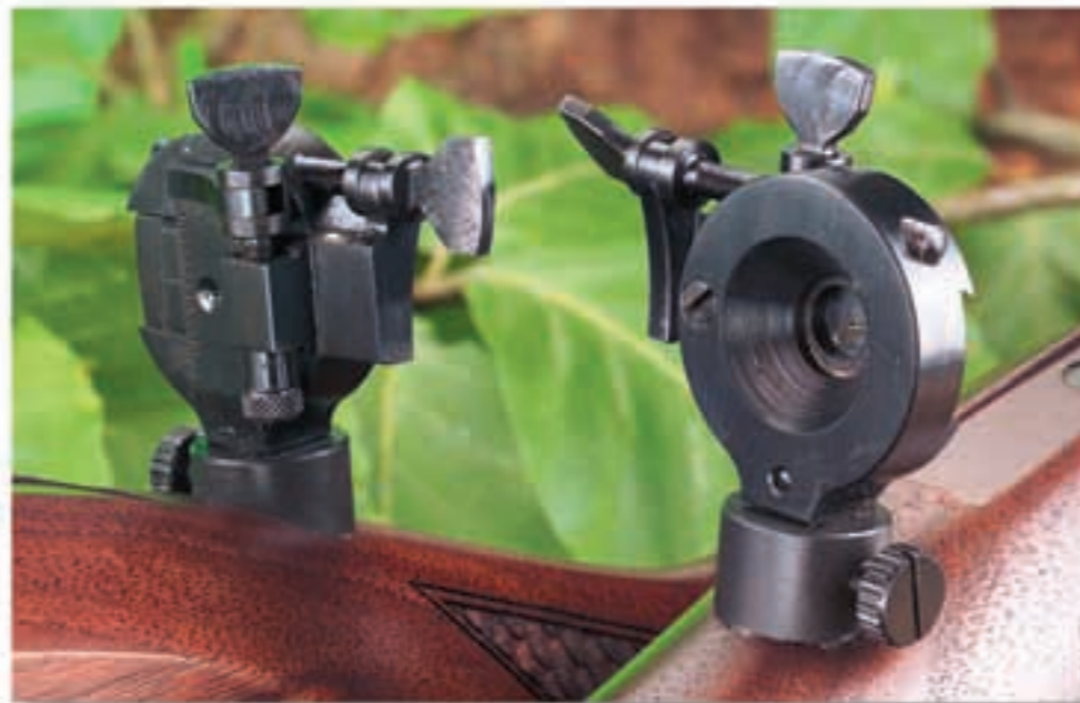
Über je zwei Flügelschrauben läßt sich das auf dem Kolbenhals sitzende Dioptr stufenlos in der Höhe und zur Seite verstellen — durch das Drehen bewegt sich die Irisblende. Auf der Vorderseite gibt es zwecks genauem Justieren zwei Strichskalen.
