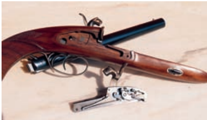
La piastra con acciarino a molla avanti. Il meccanismo è robusto e offre garanzia di sicuro funzionamento nel tempo. Le canne sono facilmente separabili per la pulizia.
